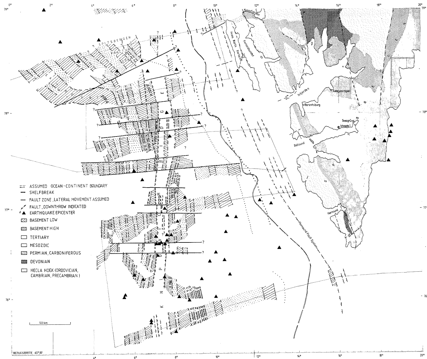
Fig. 3: Structure map; the main geological features of Spitzbergen are taken from KORNFIELD (1965). Abb. 3: Strukturkarte; die wichtigsten geologischen Einheiten von Spitzbergen sind von KORNFIELD (1965) übernommen worden.
