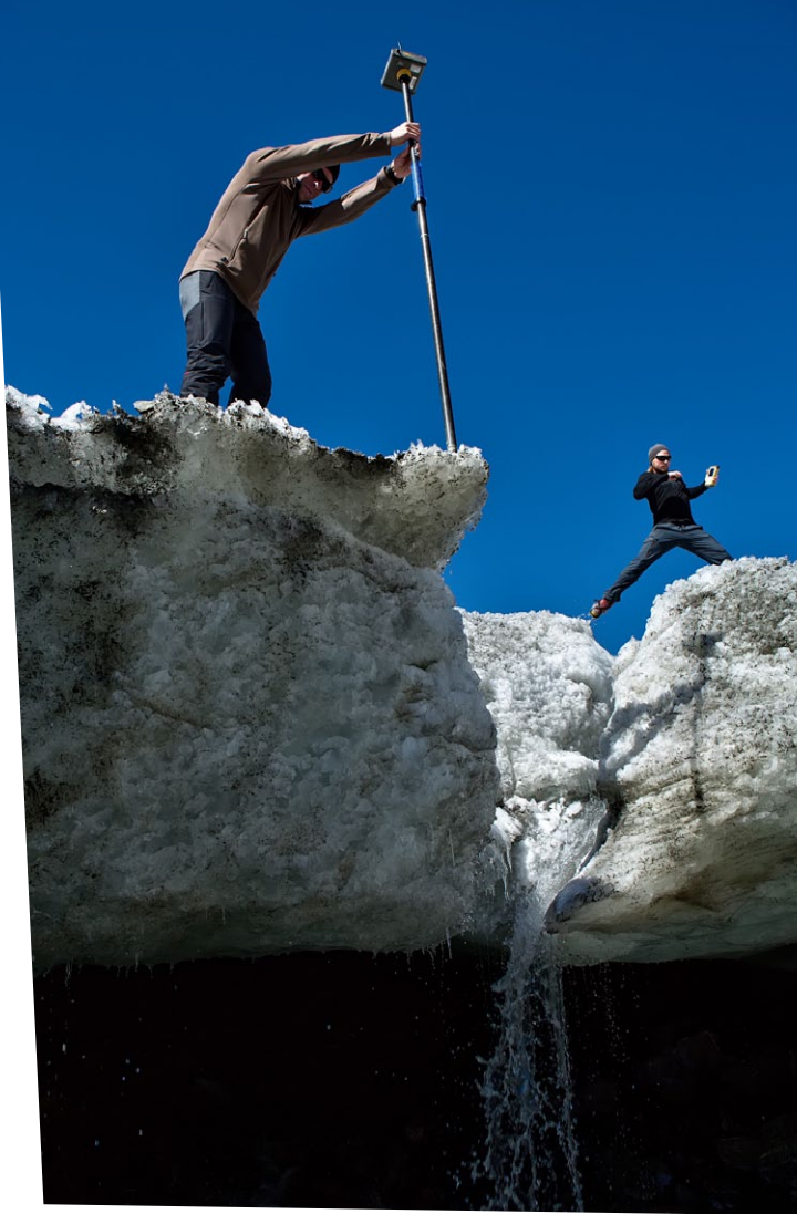
Die Einmessung der Gletscherzungen im Rofental mit differentiellem GPS.
